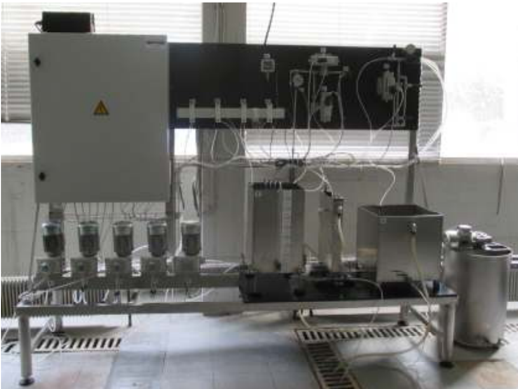
Σχήμα 2. Πειραματική διάταξη: (α) Εργαστηριακού συστήματος MBR, (β) Πιλοτικού συστήματος MBR [11].
